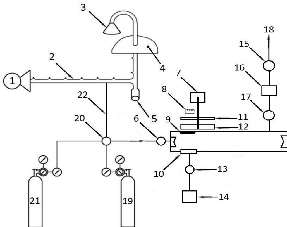
1-风机；2-多支管；3-进气口；4-房顶；5-除湿装置；6-颗粒物过滤器；7-马达；8-红外光源；9-带通滤波器；10-红外检测器；11-截光器；12-相关轮；13-放大器；14-数据输出；15-泵；16-流量控制器；17-流量计；18-排空口；19-标准气体；20-四通阀；21-零气；22-进样管路。
