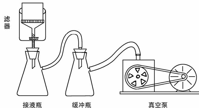
4.4 过滤：用无菌镊子夹取灭菌滤膜边缘，将粗糙面向上，贴放在已灭菌的滤床上，稳妥地固定好滤器。将适量的水样注入滤器中，加盖，开动真空泵即可抽滤除菌。
