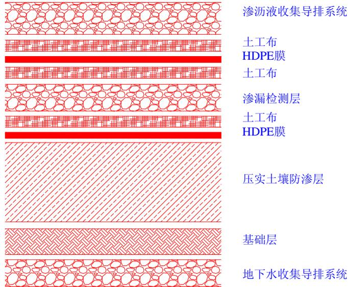
图 3.2.2-2 双层防渗结构示意图
